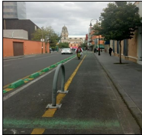
Imagen No. 14 Carril confinado, calle Aquiles Serdán
